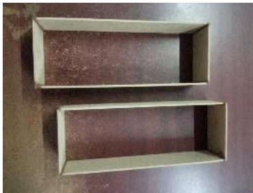
Gambar 4.15. Kotak penghubung antara honeycomb dengan test section dan fan
