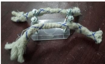
Gambar 4.1. Sumbu kompor dililit dengan kawat nickelin dan diikat pada tiang penyangga
