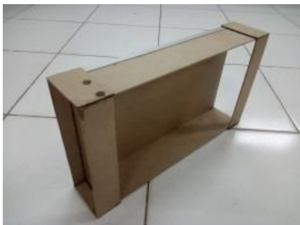
Gambar 4.16. Kotak penghubung yang sudah di tempel pada test section
