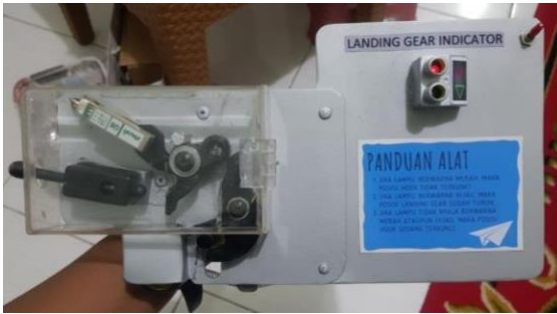
Gambar 3.7 Proses Turun Dan Naik Landing Gear Posisi Tidak Terkunci
