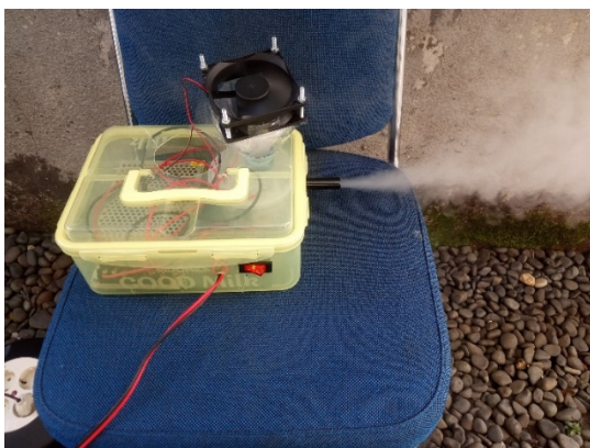
Gambar 12. Pengujian alat smoke generator dengan menggunakan baby oil.
