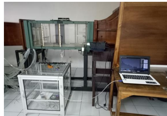
Gambar 2. Hasil alat pengembangan manometer wind tunnel yang dikembangkan berbasis Digital dengan menggunakan sensor MPXV 7002 DP
